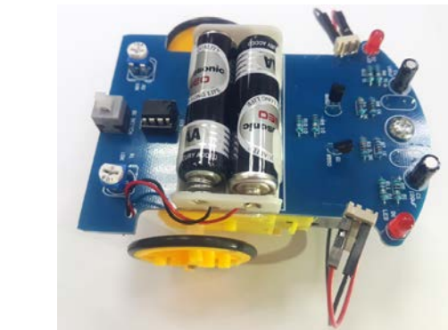
圖9 將3號電池盒黏在電路板,並焊上電池+ 一極線
